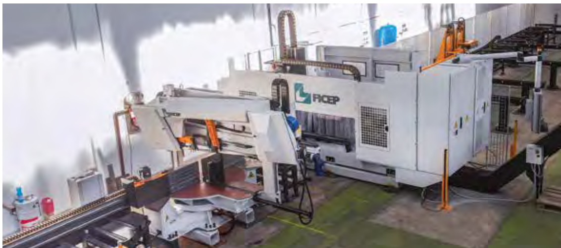
La nuova linea automatica a CNC per foratura, taglio a nastro e taglio termico per profili.
